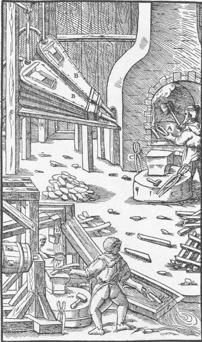
Georg Agricola: Frischfeuerofen mit Waschanlage: A. Das Frischfeuer, B. Blasebälge, C. Zange, D. Hammer, E. das fließende Wasser.
