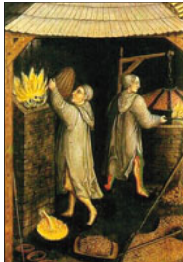
Abb. 1.3.4: Schmelzer an Bleischachtofen und Treibherd.
