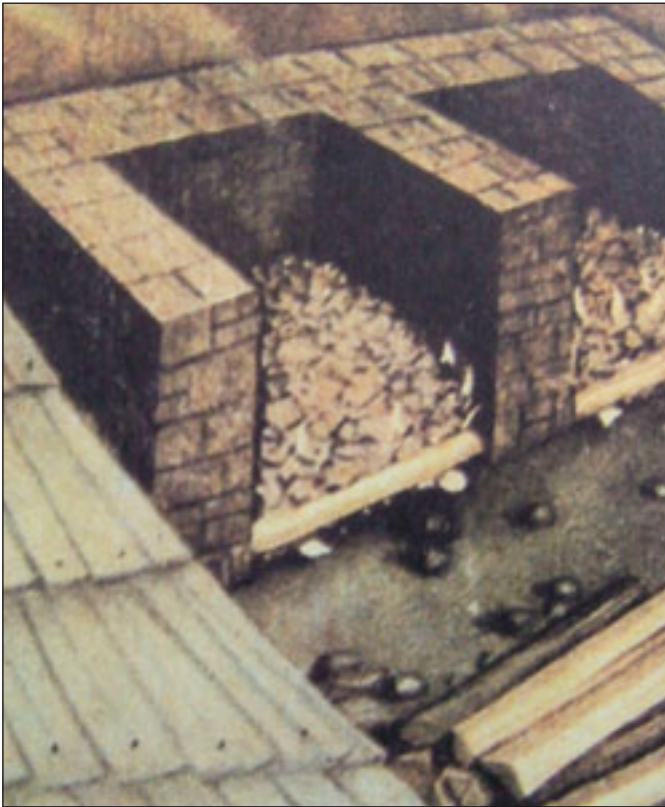
Abb. 1.3.3: Röststadel zum Abrösten des Sulfidschwefels aus dem silberhaltigen Bleierz.
