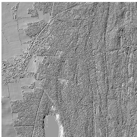
Abb. 4: Sanierungsgebiet Döbern Grube "Felix" bei Bohsdorf, RL 1214, 2 km * 2 km. Im rechten Bildausschnitt sind 4 Mio. Rasterpunkte im 1-m-Raster als sog. Shaded Relief visualisiert.
